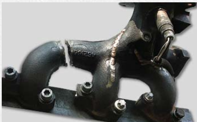
Чугунный коллектор собран из кусков и закреплён на жестком основании. Один разлом уже заварен, второй – подготовлен к сварке.
