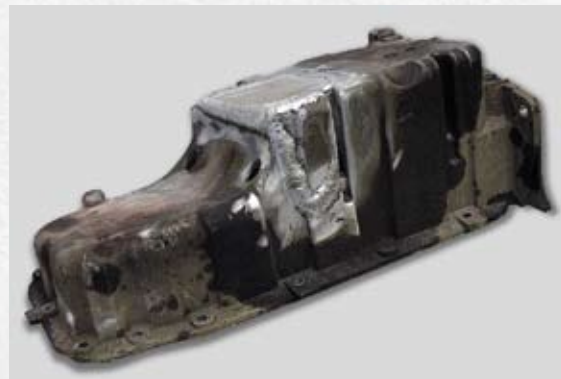
Тот же картер после ремонта.
