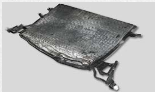
Радиатор кондиционера (конденсор) после аварии
