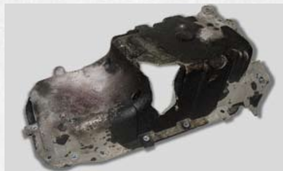
Пролом алюминиевого картера двигателя.
