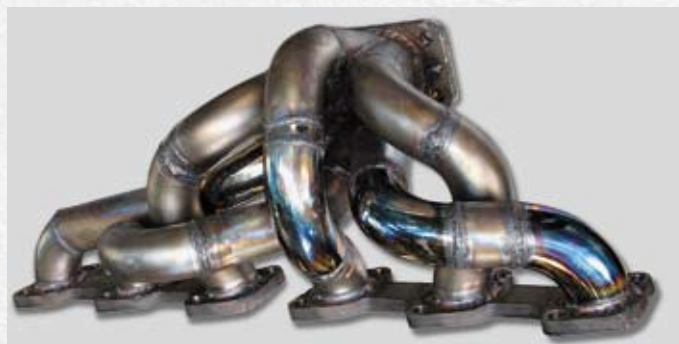
Коллектор из жаростойкой стали, изготовленный нами по индивидуальному заказу
