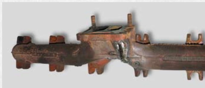
Выпускной коллектор грузовой автомашины (заварена трещина).
