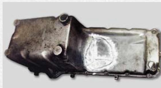
Тот же картер после ремонта.
