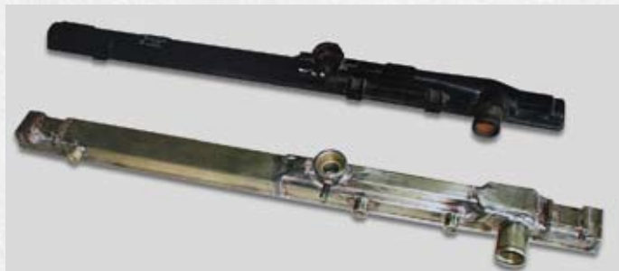
Пластмассовый бачок радиатора легковой японской машины и его алюминиевая копия.
