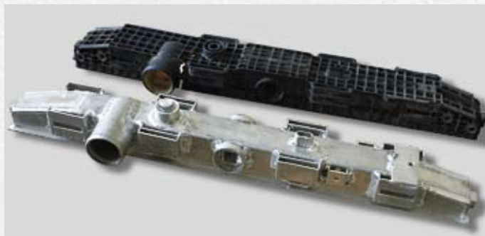
Пластмассовый бачок радиатора грузовика (с трещиной) и его алюминиевая копия.
