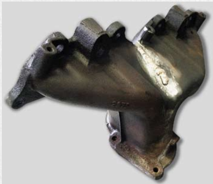
Чугунный коллектор легковой автомашины с заваренной трещиной
