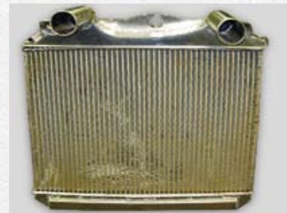
Радиаторы больших импортных грузовиков, у которых один пластмассовый бачок заменен металлическим.
