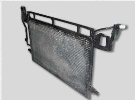
Радиатор кондиционера (конденсор) после аварии
